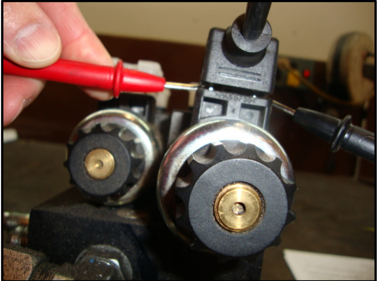
Fig. 8-4 Checking Din Plug Voltage
